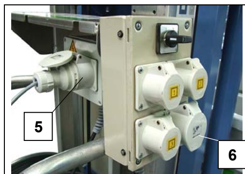
Rys. 19 podłączenie skrzynki sterowniczej
