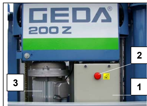
Rys. 11 skrzynka rozdzielcza sań
