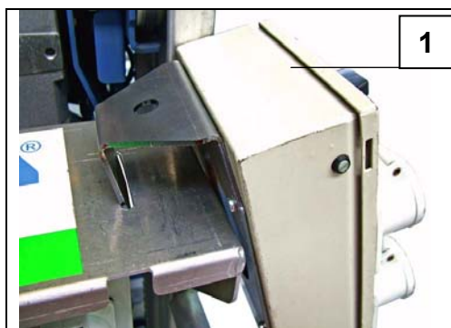
Rys. 16 podwieszenie skrzynki rozdzielczej
