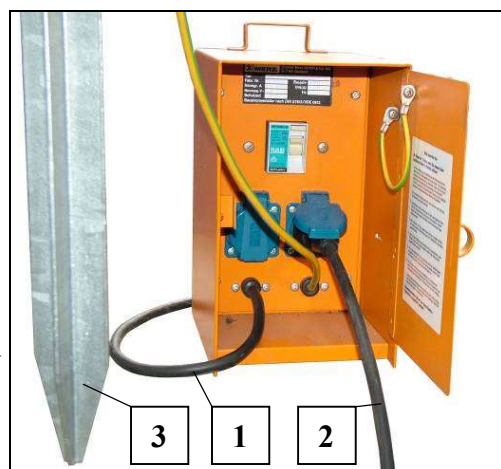
Rys. 17 Mała rozdzielnica budowlana
